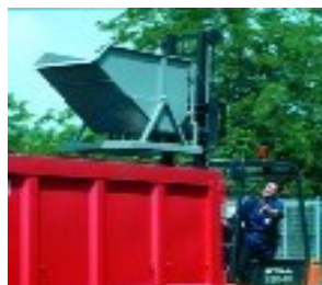
Tire del cabo de acero para accionar el me- canismo de volcado del contenedor.
